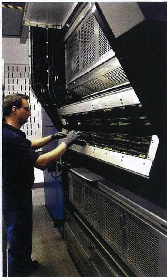
Le changement de plaque semi-automatique demande encore à être fiabilisé. Le suivi des incidents à l'aide de la GMAO permet un dialogue constructif avec le constructeur.
