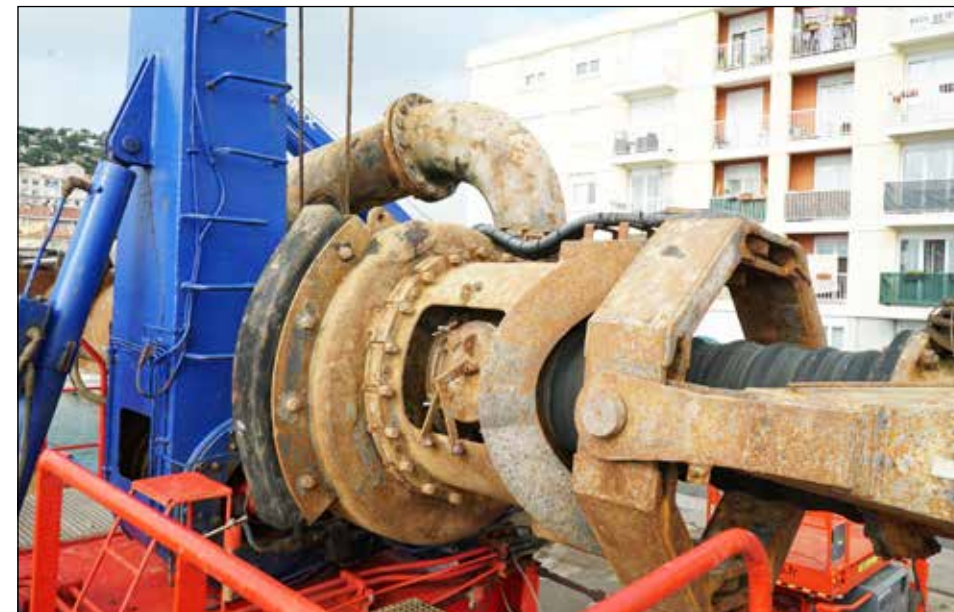
Cardankoppeling van de zuigbuizen van sleephopperzuiger Cap Croisette. De jaarlijkse stop en tweejaarlijkse dokbeurt worden gemanaged via het Cmms-systeem. Voor het dagelijkse onderhoud staat de werkplaats standby met compleet gerevideerde schroeven en zuigbuizen. De bemanning gebruikt Carl Touch voor efficiënte invoer van technische gegevens, interventieaanvragen en registratie van activiteiten. Het systeem genereert automatisch de complete baggerapportage.
